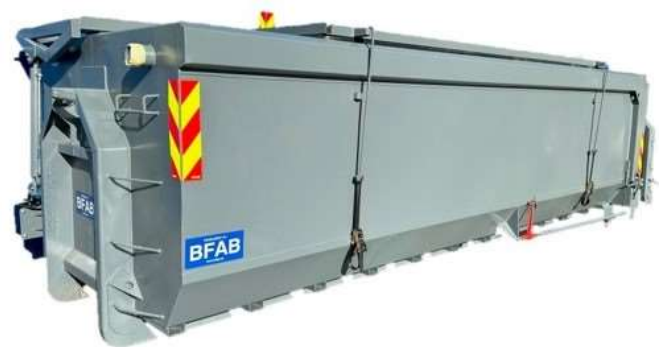
22m 3 med hydraulisk hevbart tak
